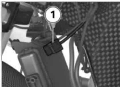
Der Stecker **1** für den Federwegsensor vorn befindet sich vorn links am Rahmen.
