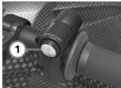
Der Warnhinweis und die LEDs können durch Druck auf die Taste OFF/PAGE **1** unterdrückt werden. Die Warnleuchte leuchtet weiterhin. Bei erneutem Druck auf die Taste OFF/PAGE **1** wird der Warnhinweis wieder angezeigt.
