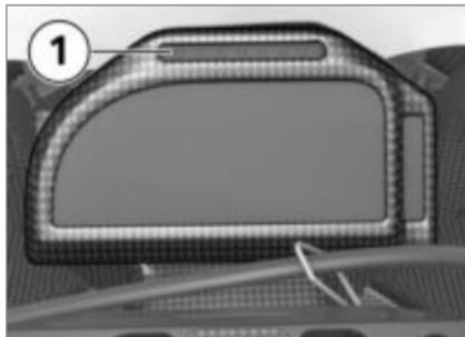
Während der Fahrt signalisiert das Leuchtdiodenband **1** die Drehzahl, bei der in den nächsthöheren Gang geschaltet werden sollte.
