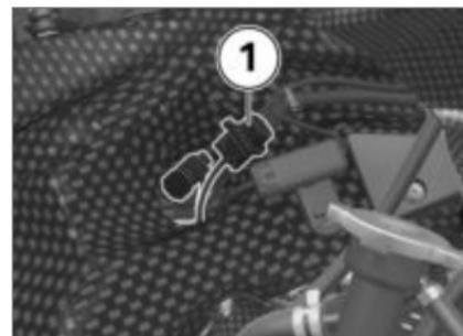
Der Stecker **1** für den Bremsdrucksensor vorn befindet sich vorn rechts am Rahmen.
