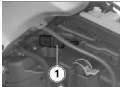
Zur Abnahme des CAN-Bus-Signals ist der Stecker **1** neben dem Steuergerät vorgesehen. Er bietet auch den Anschluss an die Spannungsversorgung des Bordnetzes und eignet sich daher, um damit z. B. eine Action-Cam an-
