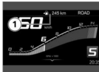
Die Reichweite **1** gibt an, welche Strecke mit dem verbleibenden Kraftstoff noch gefahren werden kann. Die Berechnung erfolgt anhand des Durchschnittsverbrauchs und der Kraftstoffmenge.
