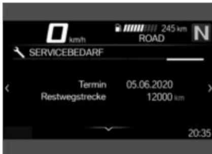
Liegt die verbleibende Zeit bis zum nächsten Service innerhalb eines Monats oder wird der nächste Service innerhalb von 1000 km fällig, so wird eine weiße Check-Control-Meldung angezeigt.
