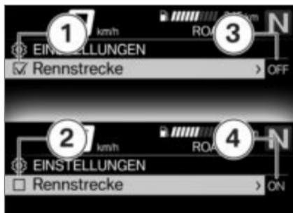
Einigen Menüpunkten ist ein Kästchen vorangestellt. Das Kästchen zeigt an, ob die Funktion ein- oder ausgeschaltet ist. Aktionssymbole nach den Menüpunkten veranschaulichen, was durch kurzes Kippen des Multi-Controllers nach rechts geschaltet wird.
