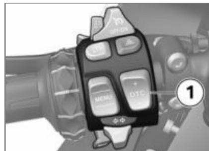
Während der Fahrt kann über die DTC-Wipptaste **1** an der linken Lenkerbedieneinheit die DTC-Einstellung verändert werden.
